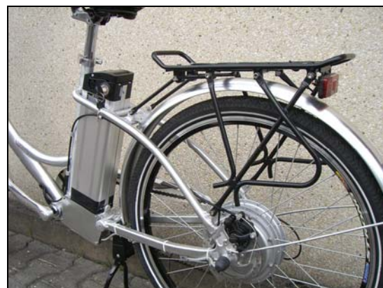
stabiler Gepäckträger bürstenloser Nabenmotor abschließbarer Li-Ionen Akku
