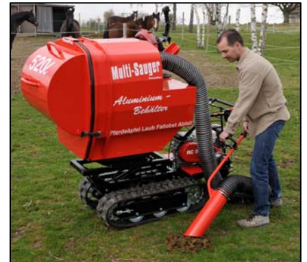
Aufgebaut auf einem Raupendumper
