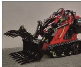
Greifzange (Kroko) Öffnung 770 mm
