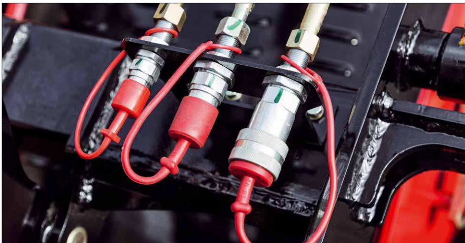
Für Anbaugeräte mit Hydraulikbetrieb stehen insgesamt fünf Anschlüsse zur Verfügung. Auch hier wird kein Werkzeug zum An- und Abklemmen benötigt
