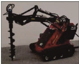
Erdbohrer Ø 200 mm Bohrtiefe 1000 mm
