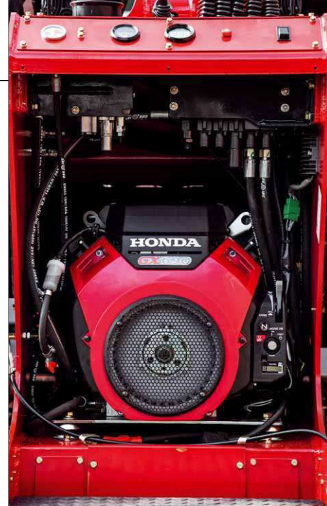
Hier sieht man den Motor sowie die beiden Ventilblöcke unterhalb der Armaturentafel
