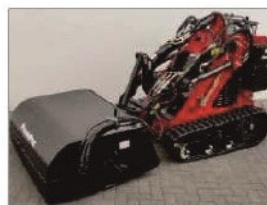
Kehmaschine 970 mm Walzendurchmesser 770 mm
