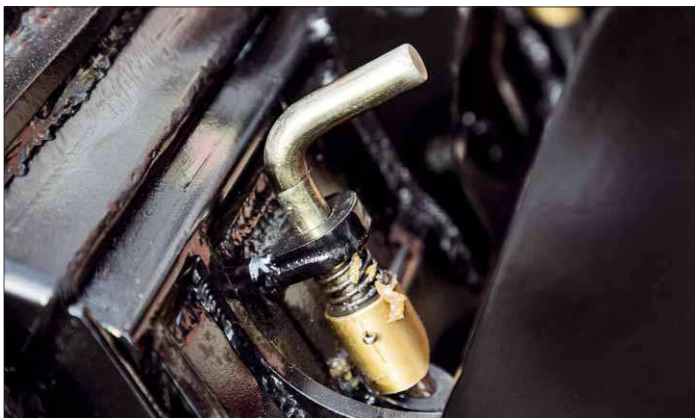
Zwei federbelastete Hebel sichern das Anbauwerkzeug. Ein Wechsel kann also werkzeuglos erfolgen
