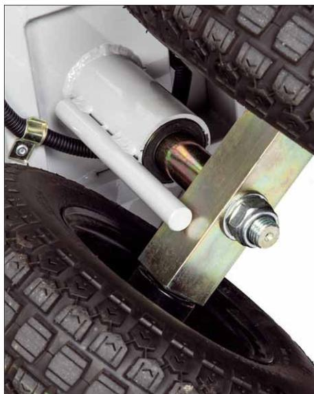
Die Zugdeichsel der AP 800 XL ist oben und unten in gekapselten Kugellagern geführt
