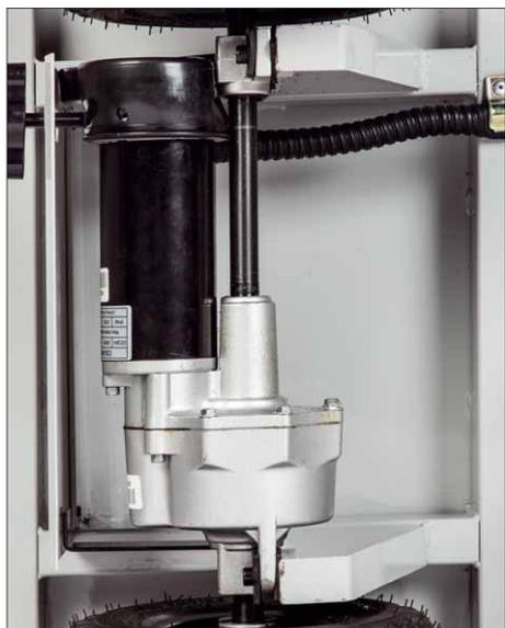
Auch an der kleinen Plattform ist die Hinterachse mit Antrieb recht massiv ausgeführt
