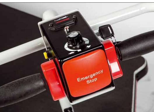
Die kompakte Bedieneinheit ist bei beiden Akku-Plattformen die gleiche. Mit dem seitlichen gelben Knopf lässt sich der Antrieb entkoppeln, so dass die Plattform manuell rangiert werden kann
