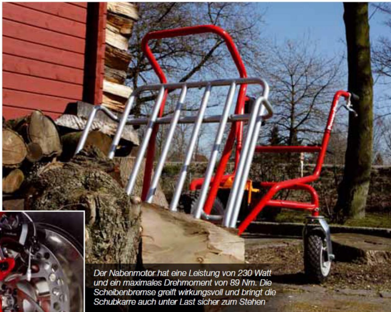
Der Nabenmotor hat eine Leistung von 230 Watt und ein maximales Drehmoment von 89 Nm. Die Scheibenbremse greift wirkungsvoll und bringt die Schubkarre auch unter Last sicher zum Stehen
